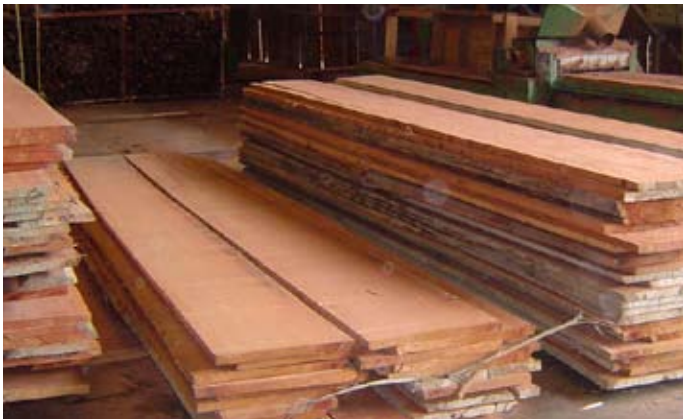
Brettware nach der Trocknung - bereit für den Zuschnitt
