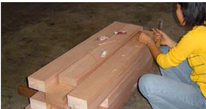
Fehler werden oberflächlich manuell ausgebessert.
